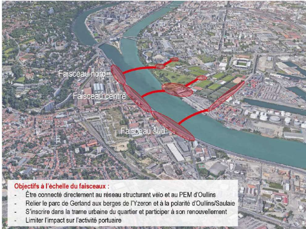
Figure 17 : Schéma des trois faisceaux de franchissement
